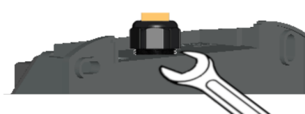
Fig. 6-15: Serrage du passe-câble à l'arrière
